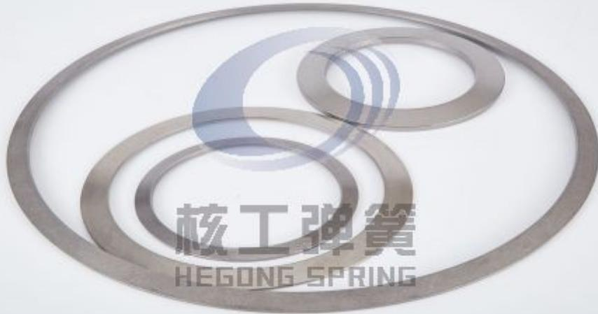
碟形弹簧的制造工艺：碟形弹簧根据厚度可分为三类，一类厚度 $T < 1.25\text{mm}$ ；第二类 $1.25\text{mm} \leq T \leq 6\text{mm}$ ；第三类 $6\text{mm} \leq T \leq 14\text{mm}$ 。不同厚度的碟形弹簧制造工艺不尽相同，情况如下：一类碟形弹簧：冲压成形→淬火→回火→抛光→强压处理→表面处理→检验。第二类碟形弹簧：冲制环坯→磨平两面→车削内外径并倒圆→锥面冷成型→高温正火→热处理→喷丸→强压→表面处理→检验。第三类碟形弹簧：圆钢下料→锻锥坯→车削加工到要求尺寸→高温正火→淬火→回火→喷丸→强压→表面处理→检验。一类碟形弹簧冲压时不需要预留加工余量，第二、三类碟形弹簧毛坯一般需预留出落-4mm机加工余量，碟形弹簧应在成型模中成型，以保证内外圆同心度等精度要求，喷丸处理是为了增加碟形弹簧的疲劳强度，强压处理可以减弱蠕变影响，增加碟形弹簧的使用寿命，表面处理可防止碟形弹簧因腐蚀而失效！徐州碟形弹簧价格哪家好，欢迎咨询核工碟形。高压开关碟形弹簧
