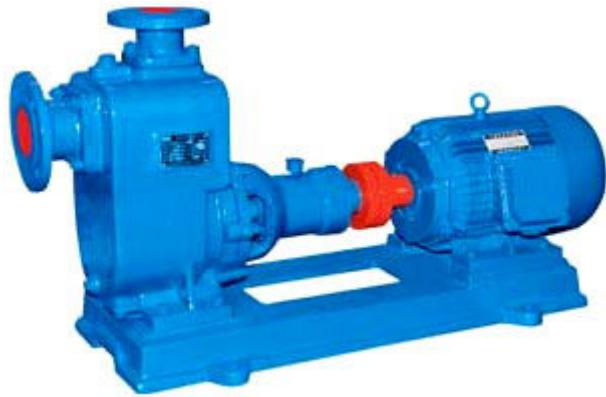
或水压)的作用下通过管网压到了进水管内。这样循环不已, 就可以实现连续抽水。在此值得一提的是: 自吸离心泵启动前一定要向泵壳内充满水以后, 方可启动, 否则将造成泵体发热, 震动, 出水量减少, 对水泵造成损坏[3] (简称“气蚀”)造成设备\*\*\*。自吸式离心泵类型编辑自吸离心泵的种类很多, 分类方法常见的有以下几种方式: 1. 按叶轮吸入方式分: 单吸式自吸离心泵双吸式自吸离心泵。2. 按叶轮数目分: 单级自吸离心泵、多级自吸离心泵。3. 按叶轮结构分: 敞开式叶轮自吸离心泵半开式叶轮自吸离心泵封闭式叶轮自吸离心泵。4. 按工作压力分: 低压自吸离心泵中压自吸离心泵高压自吸离心泵边立式自吸离心泵。自吸式离心泵性能曲线编辑水泵的性能参数如流量Q扬程H轴功率N转速n效率η之间存在的一一定的关系。他们之间的量值变化关系用曲线来表示, 这种曲线就称为水泵的性能曲线。水泵的性能参数之间的相互变化关系及相
